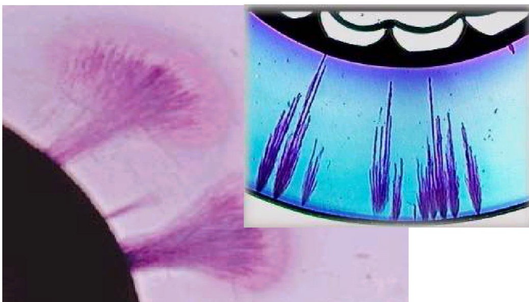
Slika 2.5: Prodor vlage u izolaciju od umreženog polietilena
