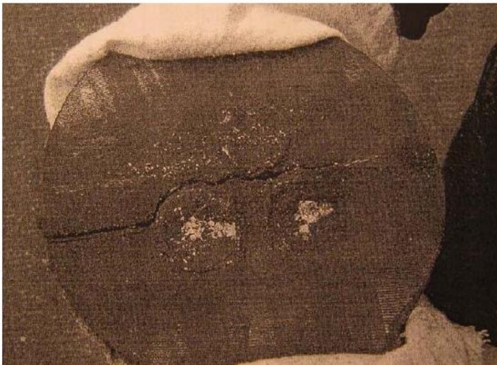
Slika 11.19. Presjek kabela s velikom pukotinom na sredini
