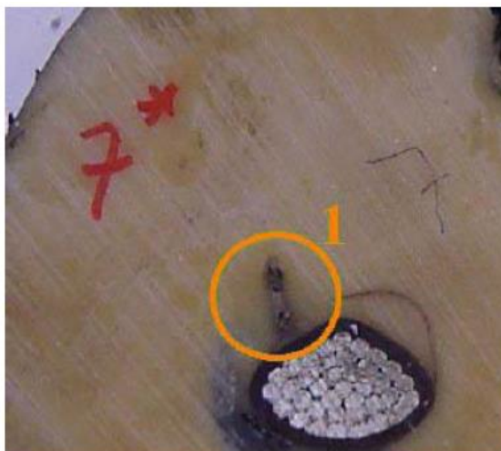
Slika 11.9. Prikaz šupljina u izolaciji od smole, koje se pojavljuju u procesu stvrdnjavanja smole
